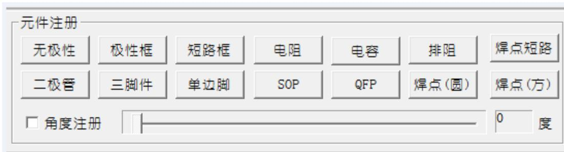
**无极性单框：**一般勾画所有规格在 0402 以内的无极性的电容和电阻的检测框。也可以做其他元件的本身标注的检测框。
