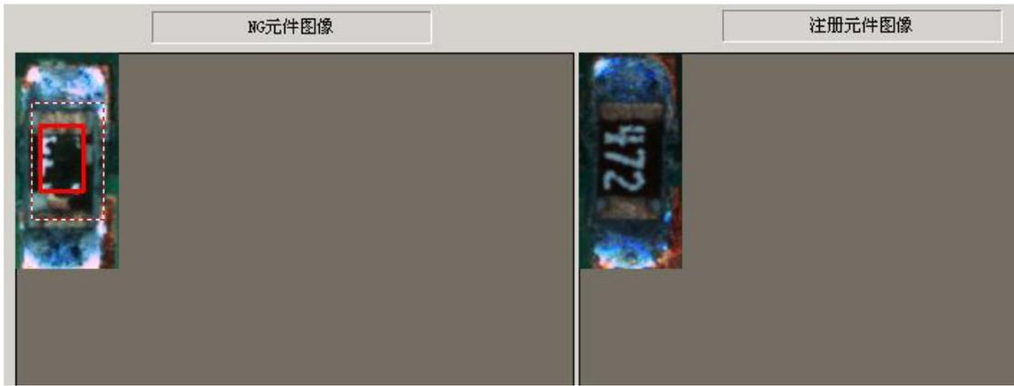
点击 [元件属性]，就会弹出注册元件时设置的信息，若经实际检测使用，认为有必要，才在此时修改当初的元件注册信息。一般出现的图像差异，只需通过 [添加组] 的方式添加较多的良品标准图像，来降低误判率。
