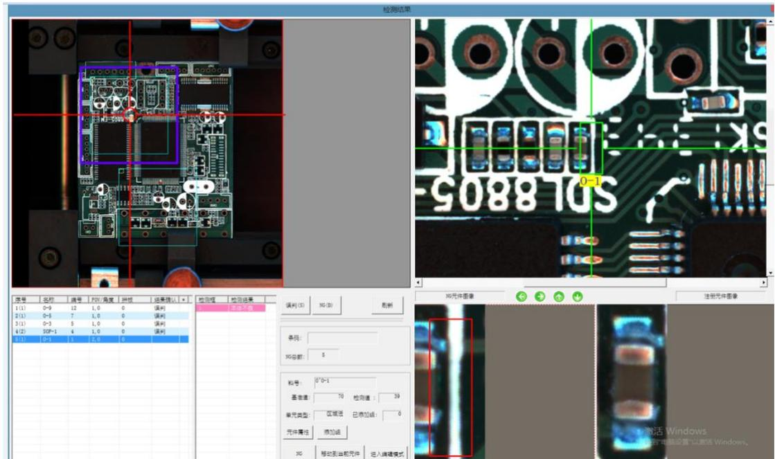
在编辑模式里选中偏移的元件框，再用鼠标左键移动到正确的元件位置上。
